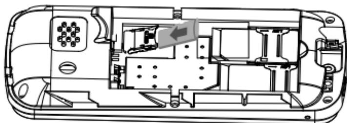
Achten Sie darauf, dass die Kontakte der Speicherkarte nach unten zeigen und dass die "Nase" entsprechend dem markierten Bereich platziert wird. Die Kontakte der Speicherkarte dürfen nicht zerkratzt oder verbogen werden. Klappen Sie dann den Rahmen wieder herunter und verriegeln ihn.
