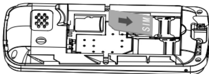
Die Kontakte der SIM-Karte dürfen nicht zerkratzt oder verbogen werden. Möglichst die Kontakte nicht mit den Fingern berühren.
